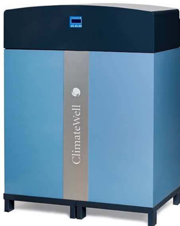
Figura 3.26. Ejemplo de enfriadora que usa como agua refrigerante y cloruro de litio como material de absorción. La fase de cristalización del material de absorción también se usa, efectuando un almacenaje interno de energía ClimateWell 10 kW
